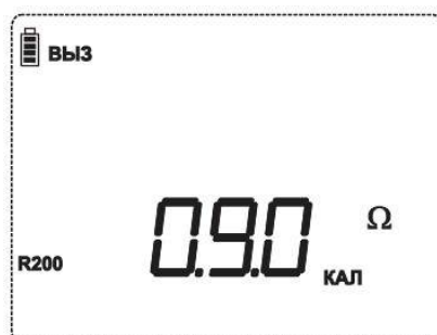
Рисунок 6.2: Пример вызова результата измерения
