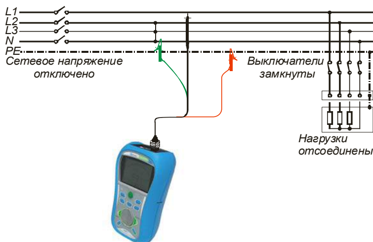
Рисунок 5.3: Подключение 3-проводного измерительного кабеля
