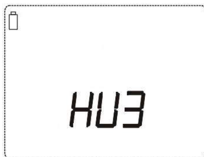
Рисунок 2.1: Индикация разряженной батареи
