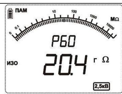
Рисунок 5.9: Результат Ризо(60сек) , отображаемый после измерения
