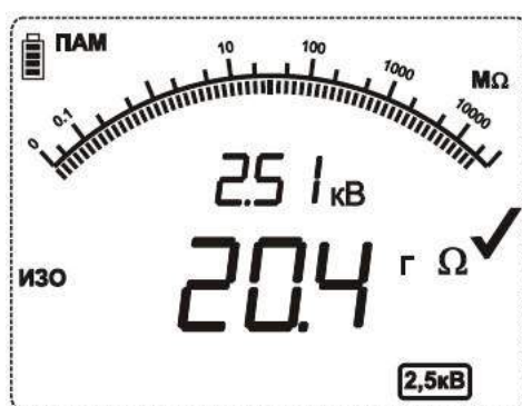
Рисунок 5.4: Пример отображения результата измерения сопротивления изоляции
