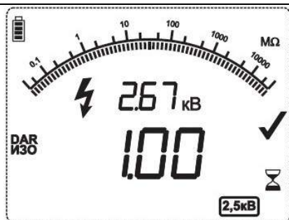
Рисунок 5.5: Результат DAR , отображаемый во время измерения (результат мигает)
