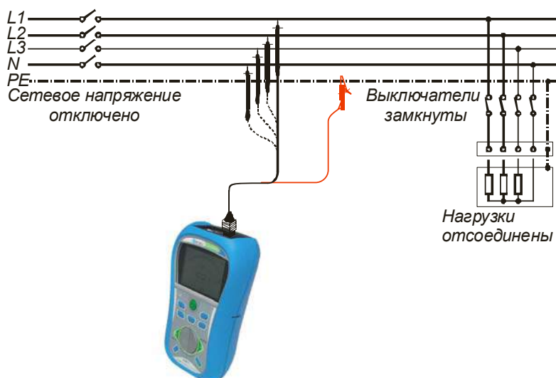
Рисунок 5.2: Подключение 2-проводного измерительного кабеля
