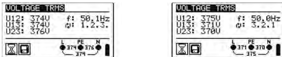
Рисунок 5.17: Примеры измерения напряжения в трехфазной цепи
