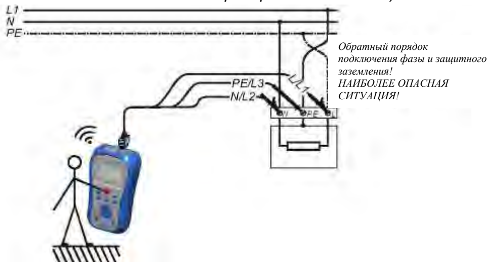
Рисунок 5.18: Поменянные местами проводники L (фаза) и PE (ЗЗ) (применение кабеля проверки подключения)
