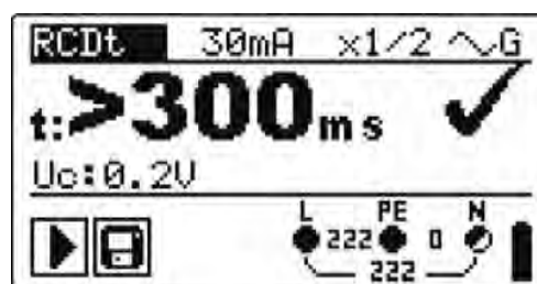
Рисунок 5.4: Пример результатов измерения времени отключения
