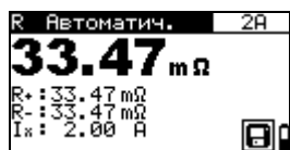
Рисунок 6.4: Примеры результата измерения сопротивления
