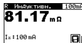
Рисунок 6.4: Примеры результата измерения сопротивления
